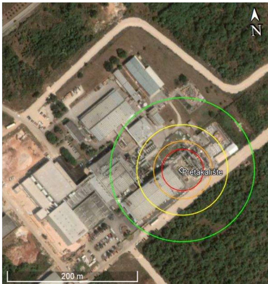
Slika 27. Zone ugroženosti u slučaju ispuštanja etil-acetata i nastanka eksplozije
