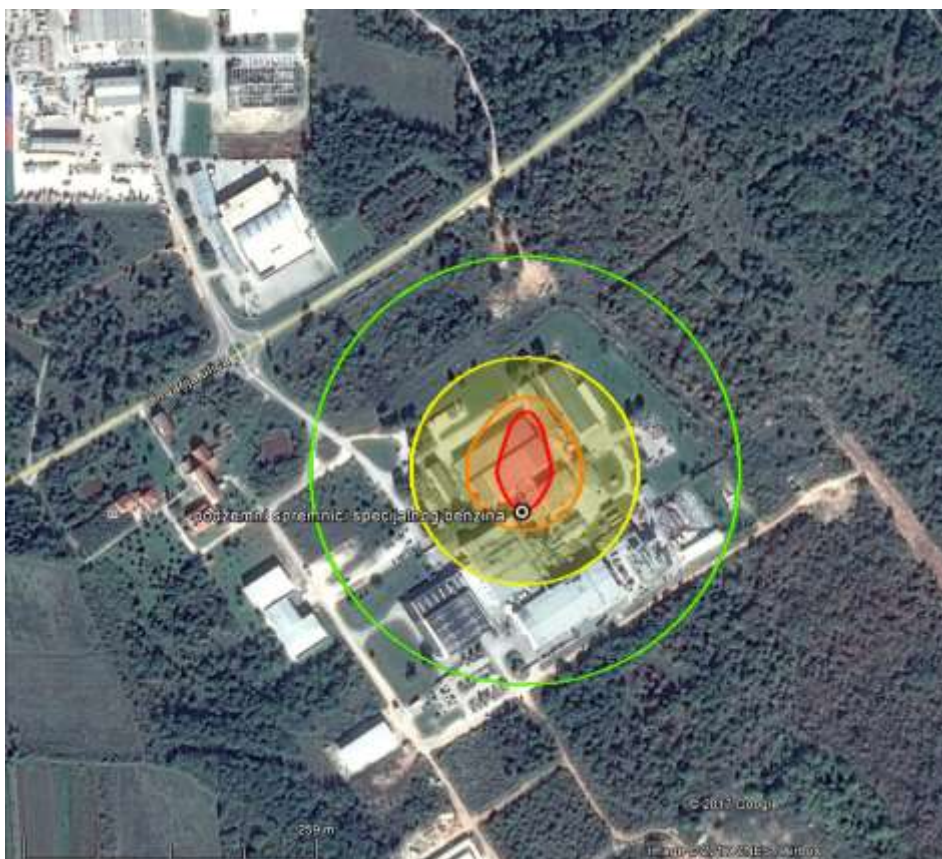
Slika 29. Prikaz zona ugroženosti u slučaju ispuštanja velike količine benzina iz autocisterne i nastanka eksplozije na lokaciji tvrtke Sipro d.o.o.
